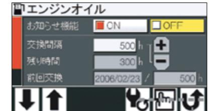
作動油や燃料フィルタの交換間隔を設定し、交換時期になるとモニタにメッセージを表示します。計画的なメンテナンスをサポートします。
