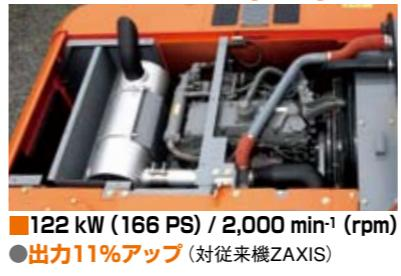
排出ガス3次規制に対応するため採用した新しいタイプの燃料噴射システムです。燃料ポンプを超高压で駆動し、気筒ごとのインジェクタに燃料を配分して噴射するシステムです。さらに、電子制御により1,000分の1秒単位で燃料の噴射タイミング、噴射量をきめ細かに制御。この結果、燃料噴射量の最適化が図れ、高出力化ならびに不完全燃焼によるPM(黒煙などの粒子状物質)低減や低燃費を実現します。
