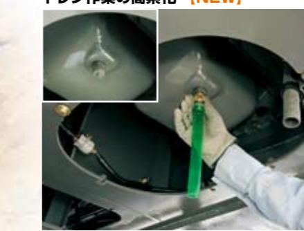
エンジンオイルパンにドレンカプラを装備。備え付けのノズルホースにより、容易にドレン作業が行えます。
