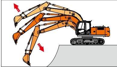
ブーム下げ時のフロントの重さを利用して、圧油をブーム回路内で循環(再生)する機構。この結果、ポンプからの圧油を集中的にアームに供給することができ、アーム/ブーム下げ複合操作時のアーム動作のスピードアップが大幅に図られました。
