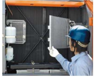
エアコンコンデンサを開閉式にすることで、エアコンコンデンサやその裏側に配置されたラジエータなどの清掃を簡素化しました。
