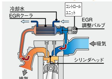
一度燃焼させた排出ガスの一部を吸入空気と混合し、再燃焼させる機構です。燃焼室内の酸素濃度を抑制することで、高出力を確保しつつ大気汚染物質であるNOx(窒素酸化物)の排出低減と低燃費を実現します。
