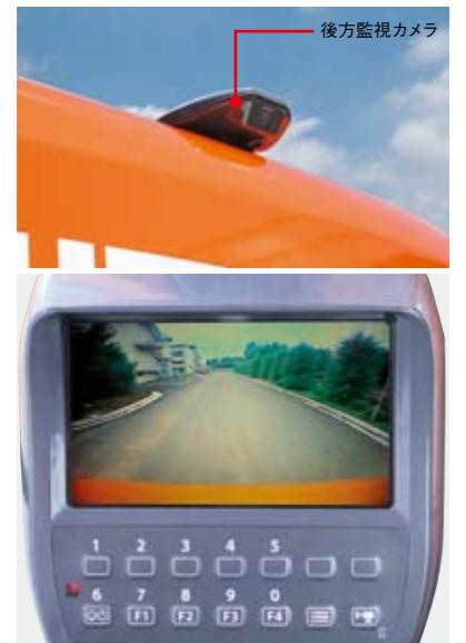
カウンタウエイト部に後方監視カメラを搭載。キャブ内のモニタで後方を確認でき、後進時の確認に役立ちます。
