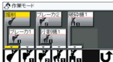
アタッチメント取付け時の煩雑な油圧回路切替えや流量切替えは、「作業モード選択」画面からワンタッチ操作で行えるため、ブームや車体に上ってのバルブ切替え作業は不要です。
