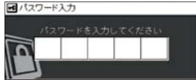
エンジン始動時に、3～5桁の暗証番号を正しく入力しないと始動しないテンキーシステムを採用。車両の盗難やいたずらなどを予防します。
