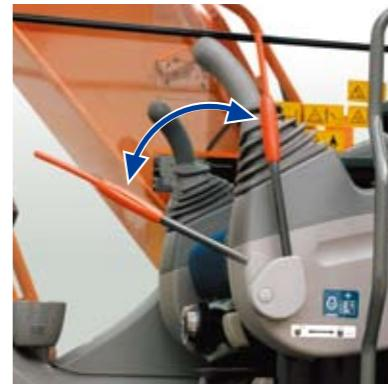
ロックレバーが完全にロックしていないとエンジンが始動できないニュートラルエンジンスタート機構を採用。レバーに触れていることに気づかずエンジンを始動して、急に機械が動いてしまうことを防ぎます。
