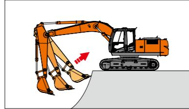
今まで、タンクに戻していたブーム戻りの圧油をアーム動作に再利用しました。この機構により、掘削時のアーム引き動作のスピードアップが大幅に図られました。
