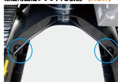
輸送時の機械固定用フック穴をトラックフレームの下フランジ部前後計4ヶ所に設けました。
