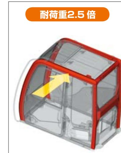
キャブの強度、剛性が大幅にアップし、転倒に対する安全性を向上。この構造は日本のJCMAが規定する安全基準（EOPS）に適合しています。例えば、キャブ上端部に横向向の荷重を加えた場合、従来機ZAXISに比べ約2.5倍の荷重に耐えることができます。
