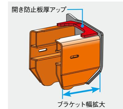
アイドラブルケット開き防止板厚を増加。外方向への開き防止と、トラックリンクおよびローラ類などの足回り部品の耐久性が向上しました。
