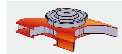
Xビーム構造のボックス寸法拡大や構造改良により、断面性能が最大で35%向上(対従来機ZAXIS)。さらに、上下板には1枚板の曲げ構造を採用しました。溶接部を減らすことと、Xビーム構造の強度および品質が向上しました。
