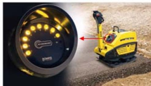
表示装置には、締固め状況(地盤剛性)を表示する10個の黄色LEDランプと前後進型振動コンパクターの異常振動を表示する1個の赤色LEDランプが備えられています。
